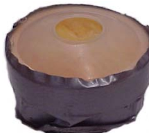
Combinación inapropiada de cartucho y filtro. (Partes de diferentes marcas sujetas con cinta adhesiva.)
